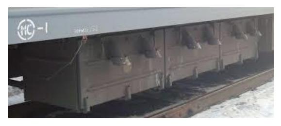
**Аккумулятором** называется химический источник тока, который способен накапливать и сохранять электроэнергию, полученную от подвагонного генератора или от подзарядного устройства, а затем отдавать её.
