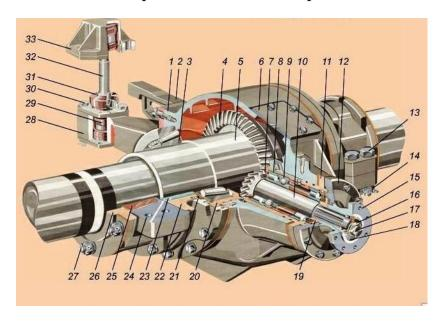
2. карданный вал представляет собой пустотелую трубу с 2 шарнирами для крепления с одной стороны с редуктором, а с другой стороны с генератором;
