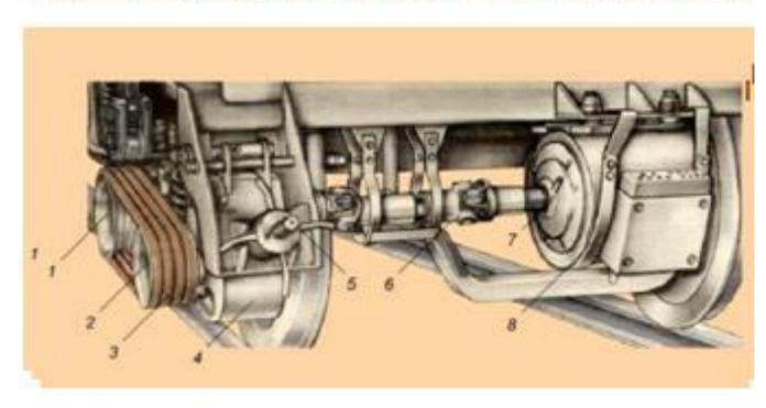
Рис.1. Розташування текстропно-редукторно-карданного приводу: 1 - ведучий шків; 2 - ведений шків, 3 - чотири приводних ременя; 4 редуктор; 5 - натягач; 6 - карданний вал; 7 - генератор; 8 - запобіжний пристрій
