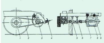
1 — ведущий шкив; 2 — клиновые ремени 3 —ведомый шкив. 4 натяжное устройство. 5 предохранительные скобы карданного вала. 6 — карданный вал. 7- предохранительные скобы генератора. 8-генератор. 9- подвеска генератора.
