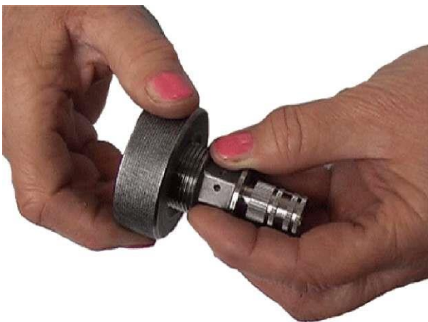
Рис. 9. Контроль різьби прохідним різьбовим кільцем
