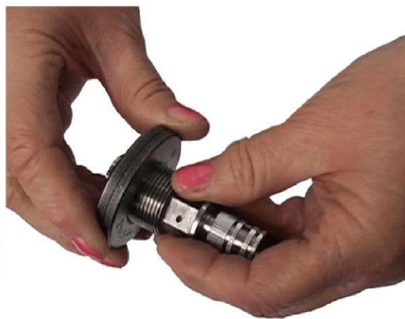
Рис. 10 Контроль різьби непрохідними різьбовим кільцем
