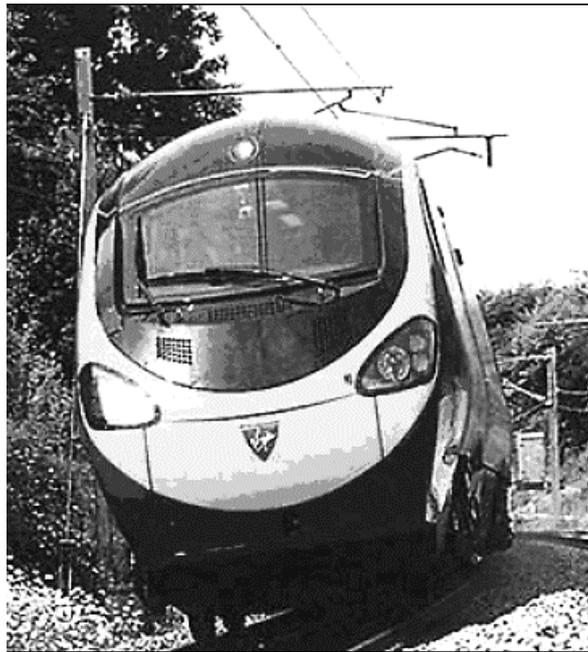
Рис. 2.29. Електропоїзд компанії Virgin серії 390 Pendolino Britannico з вагонів з кузовами, що нахиляються
