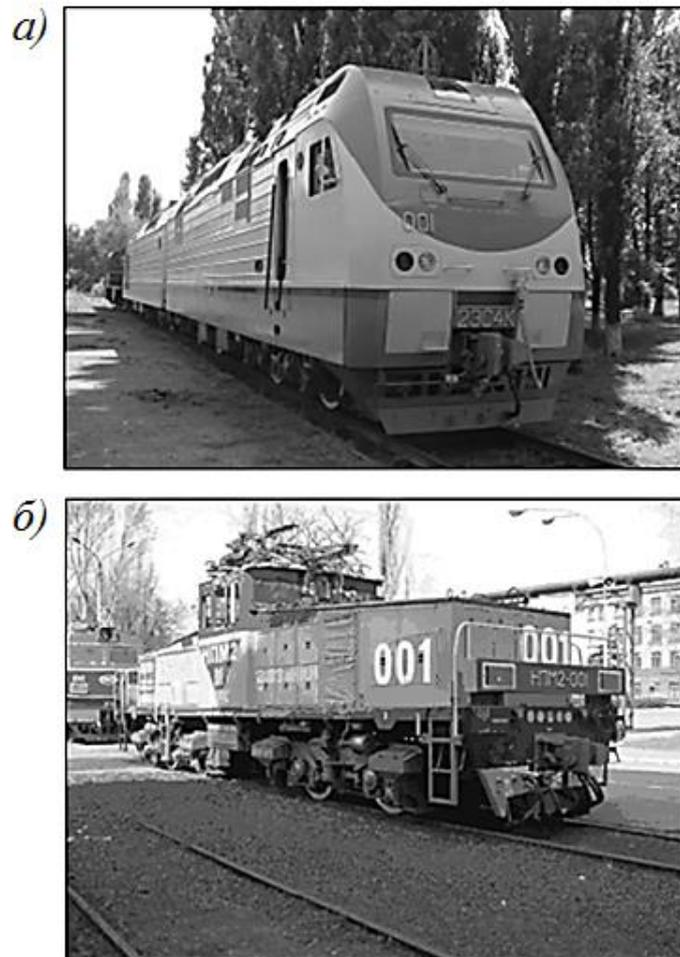
Рис. 2.2. Кузов вагонного (а) і капотного (б) типів
