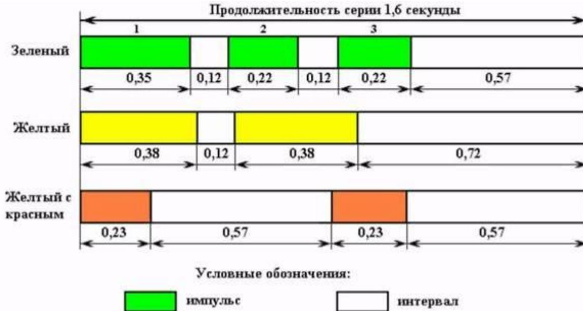
Рис. 9.2 Схема кодов локомотивной сигнализации
