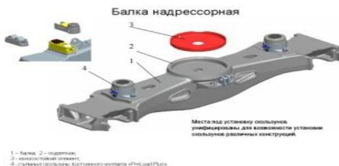
Балка имеет подпятник 1, полку 7 с кронштейном 2 рычажной передачи, опоры скользящих 3, выемки 5 для фрикционных клиньев, выступы 4, удерживающие внутренние пружины и бурты 4, ограничивающие смещение наружных пружин.
