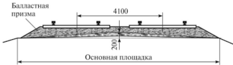
На трехпутных участках и четырехпутных участках расстояние между осями второго и третьего пути должно быть не более 5000 мм
