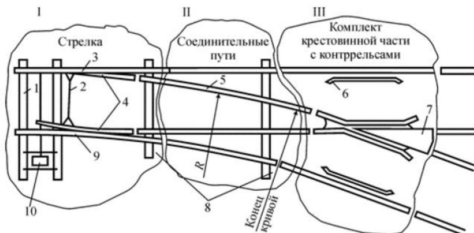
Стрелка состоит из двух рамных рельсов 9, двух острьяков 4, стрелочной тяги 2, переводного механизма 10, переводной кривой 5, контррельсов 6, сердечника 7, опорных, упорных и крепежных деталей.
