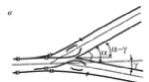
д) несимметричные разносторонние – оба пути направлены в разные стороны под разными углами.
