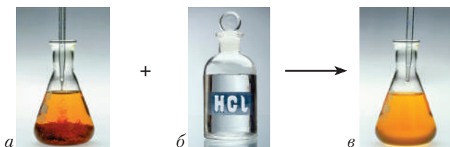
Рис. 39. Розчинення ферум(III) гідроксиду під час взаємодії з хлоридною кислотою: а – ферум(III) гідроксид; б – хлоридна кислота; в – прозорий розчин ферум(III) хлориду
