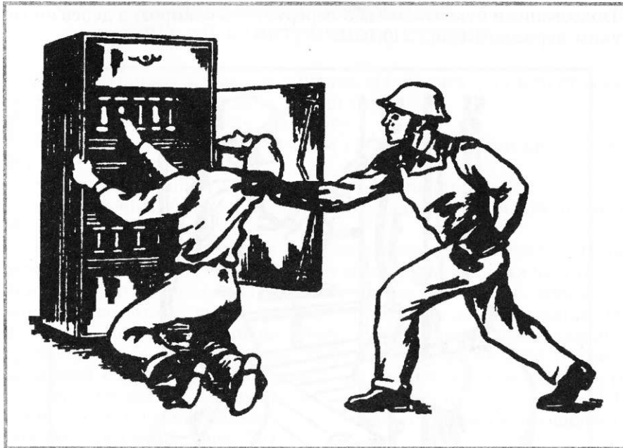
Рис. 22. Відокремлення потерпілого від струмопровідної частини, що знаходиться під напругою до 1000 В
