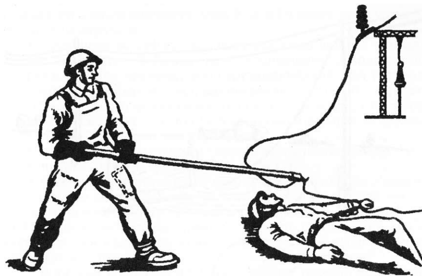
Рис. 23. Звільнення потерпілого від дії струму в установках понад 1000 В відкиданням проводу ізольованою штангою
